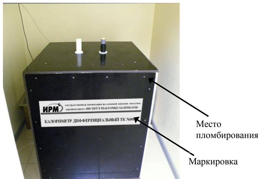
Рисунок 2 – Фото общего вида калориметрического блока с указанием мест пломбирования и маркировки
