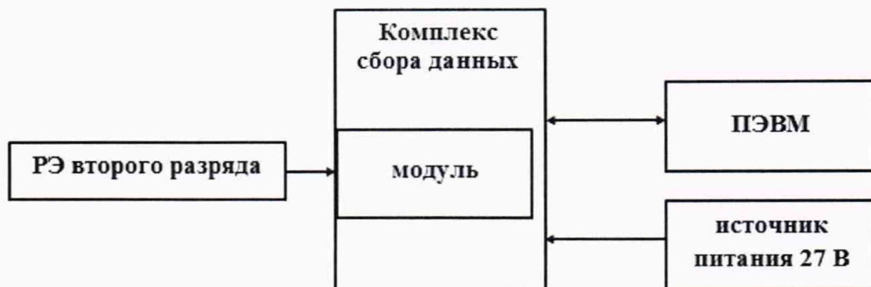
Рисунок 1 - Схема для проведения измерений при проверке опробования
