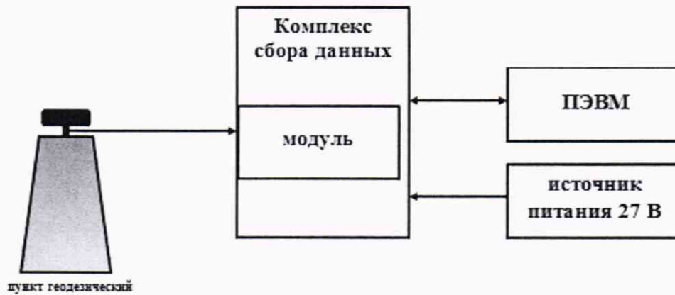
Рисунок 2 – Схема для проведения измерений при определении погрешности определения координат местоположения на пункте геодезическом
