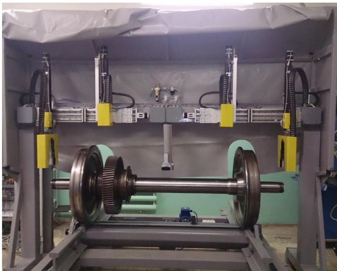
Рисунок 1 – Общий вид Комплексов для измерений геометрических параметров колесных пар «ГЕОМЕТРИКС КП»
