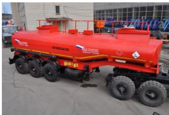
Рисунок 1 – ППЦ с двумя секциями
