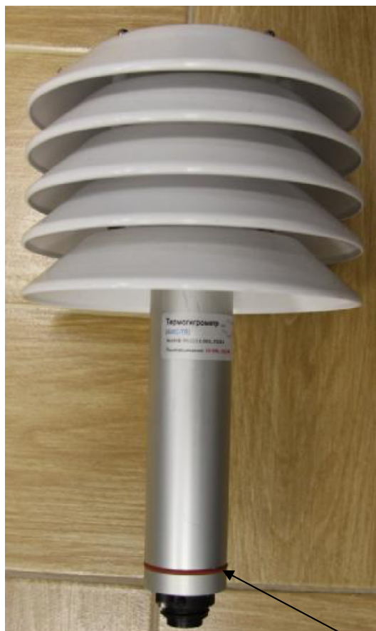
Рисунок 1. Внешний вид АМС-ДТВВ с указанием места пломбирования
