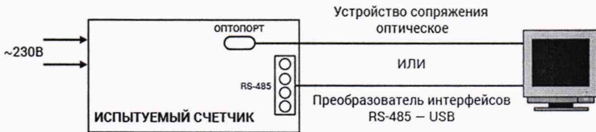
Рисунок Б.2 – Схемы подключения для настройки выхода счетчика
