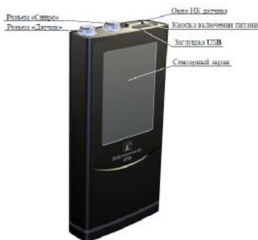
Рисунок 1 - Внешний вид виброанализатора 8710
