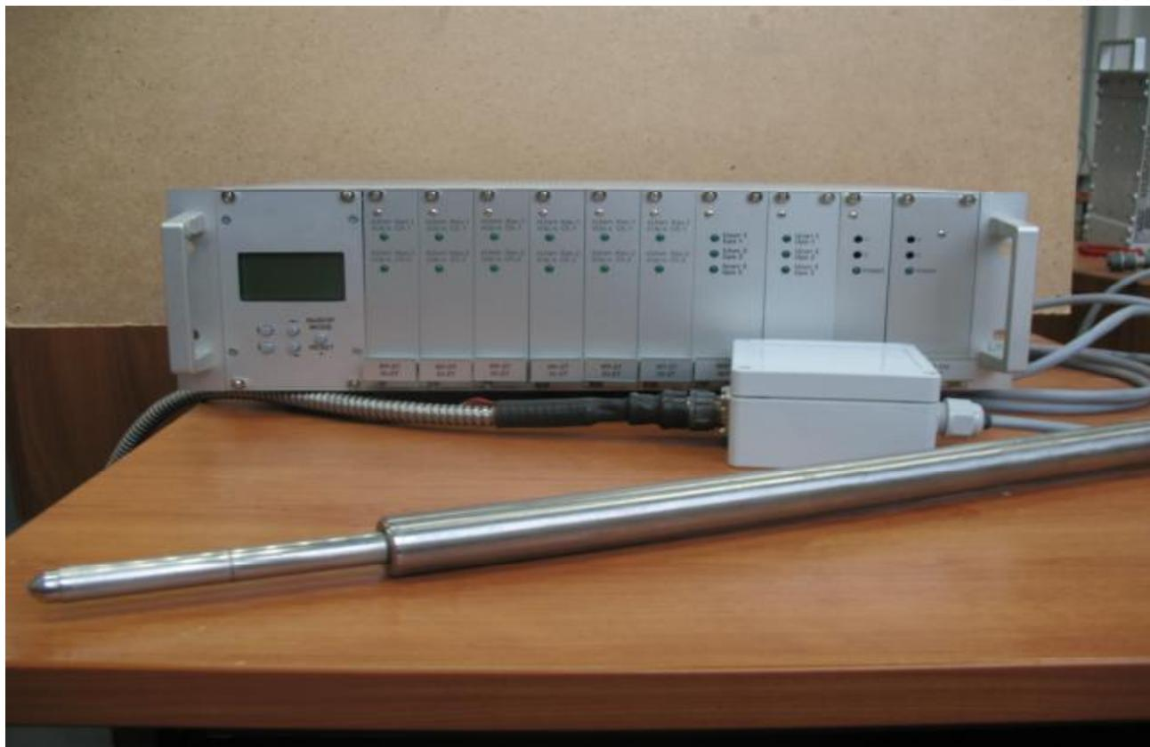
Рисунок 2. Общий вид каналов измерительных относительного перемещения ДКНБ.401163.001
