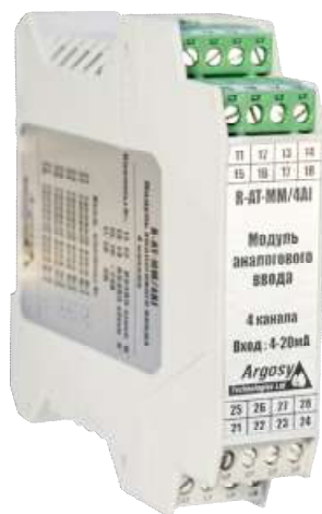
Рисунок 1 – модуль аналогового ввода (R-AT-MM/4AI)
