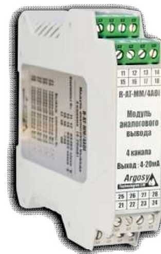
Рисунок 2 – модуль аналогового вывода (R-AT-MM/4AOI)
