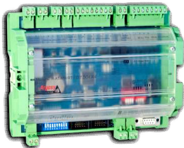
Рисунок 9 – модуль вычислительный (R-AT-MM/RTU)
