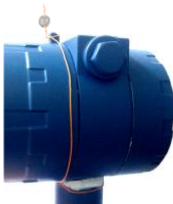
Рисунок 2 – Место пломбирования счетчиков-расходомеров массовых СКАТ
