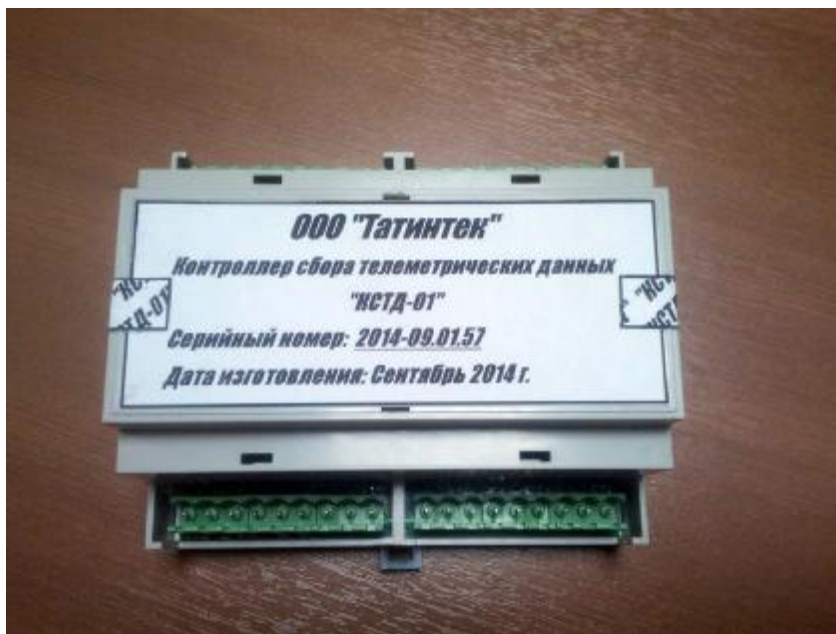
Рисунок 1 - Пломбировка корпуса контроллера «КСТД-01» (вид спереди)
