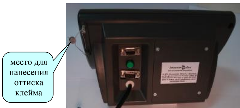
Рисунок 6 Схема защиты от несанкционированного доступа в настройки индикатора ВУ-2010 и обозначение места для нанесения оттиска клейма.
