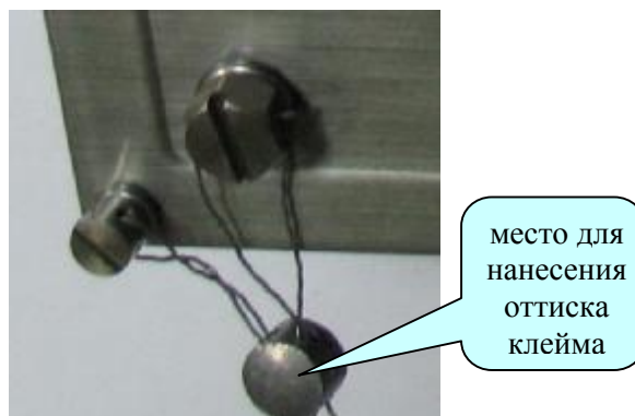
Рисунок 5 Схема защиты от несанкционированного доступа в настройки индикаторов СИ-2001А, СИ-2400BS и обозначение места для нанесения оттиска клейма.
