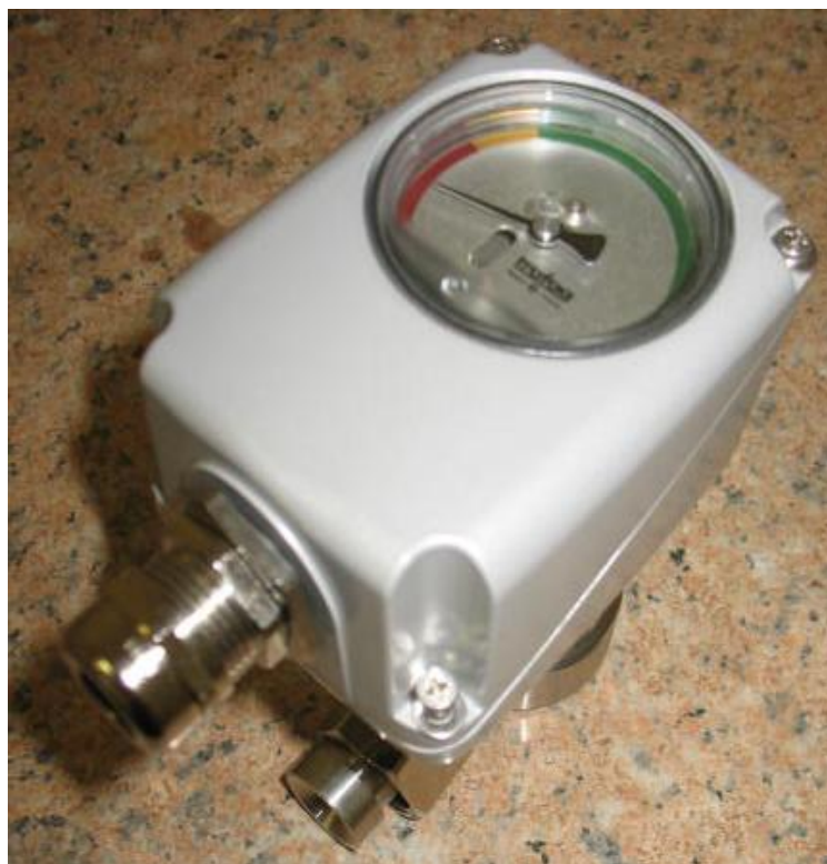
Рис. 2. Внешний плотномера элегаза серии 879X с индикатором без оцифрованных отметок шкалы.
