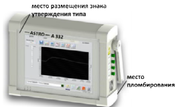
Рисунок 5 – Внешний вид АСВОД ASTRO A332 с указанием места пломбирования и размещения знака утверждения типа
