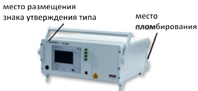
Рисунок 4 – Внешний вид АСВОД ASTRO A357 с указанием места пломбирования и размещения знака утверждения типа
