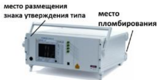
Рисунок 8 – Внешний вид АСВОД УОВОД 30404-2 с указанием места пломбирования и размещения знака утверждения типа
