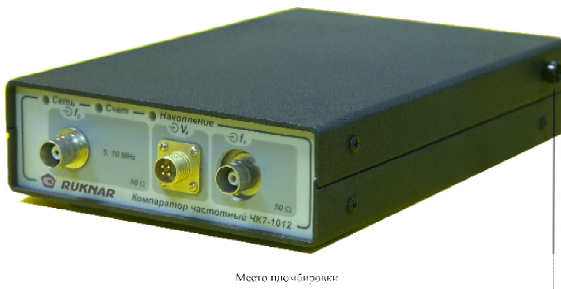
Рисунок 1 – Общий вид компараторов и место пломбировки от несанкционированного доступа.
