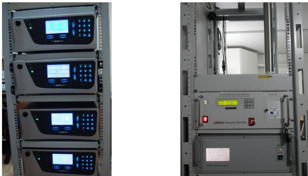
Рис. 2 Фотография внешнего вида газоанализаторов и анализатора пыли в приборных стойках
