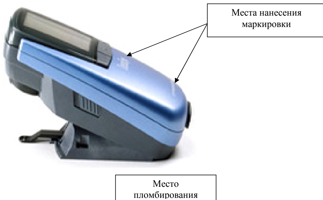
Рисунок 1 - Общий вид денситометра X-Rite DensiEye 100 с указанием места нанесения маркировки и места пломбирования
