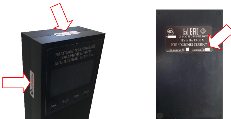
Рисунок 2 – Место пломбирования влагомера и место нанесения заводского номера
