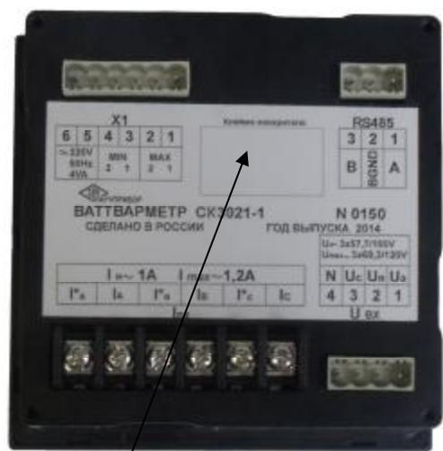
Рисунок 4 – Место нанесения поверительного клейма
