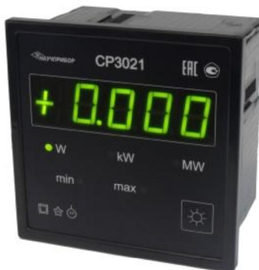
Рисунок 1 – Общий вид ватметров CP3021
