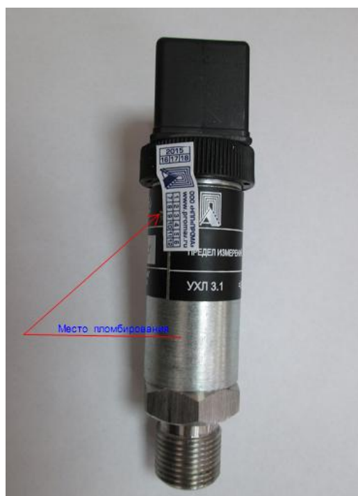
Рисунок 2 - Места пломбирования датчиков
