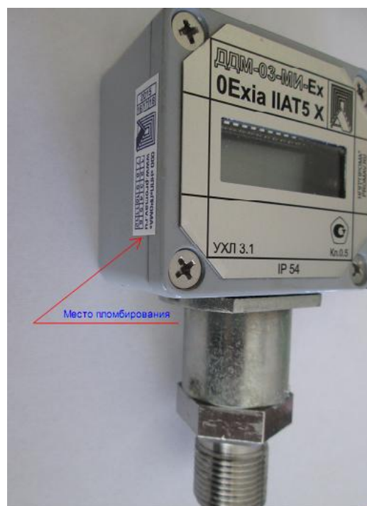
Рисунок 2 - Места пломбирования датчиков
