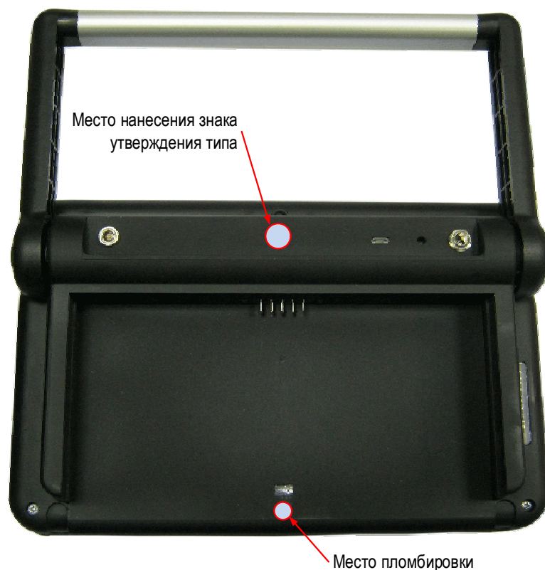
Рисунок 4 – Место пломбировки корпуса дефектоскопа А1214 EXPERT (аккумулятор снят, ручка поднята) и место знака утверждения типа
