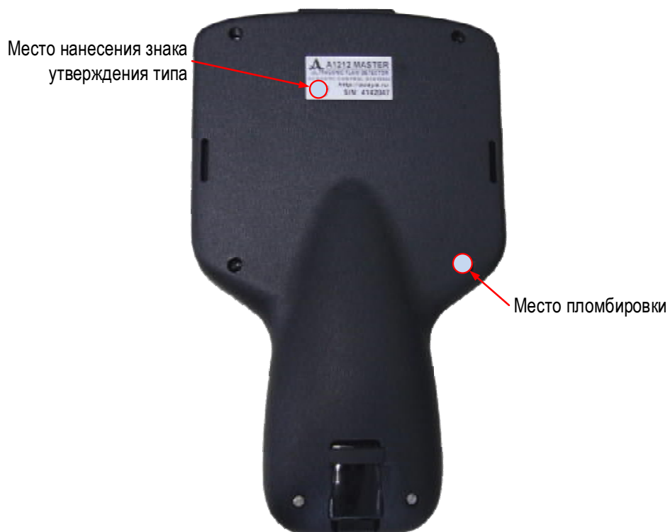
Рисунок 3 – Место пломбировки корпуса дефектоскопа A1212 MASTER и место знака утверждения типа
