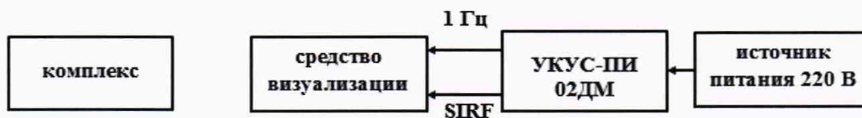
Рисунок 1 - Схема проведения измерений при определении погрешности синхронизации шкалы времени
