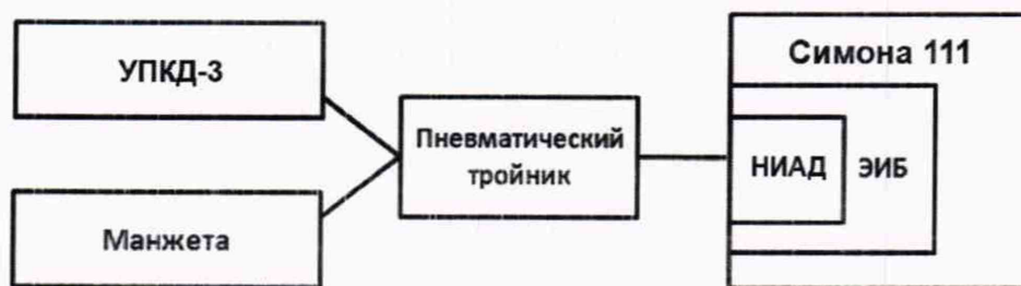
Рисунок 5 - Схема подключения приборов при определении метрологических характеристик канала НИАД.
