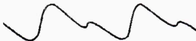
Рисунок 6 - Кривая испытательного сигнала канала ФПГ.
