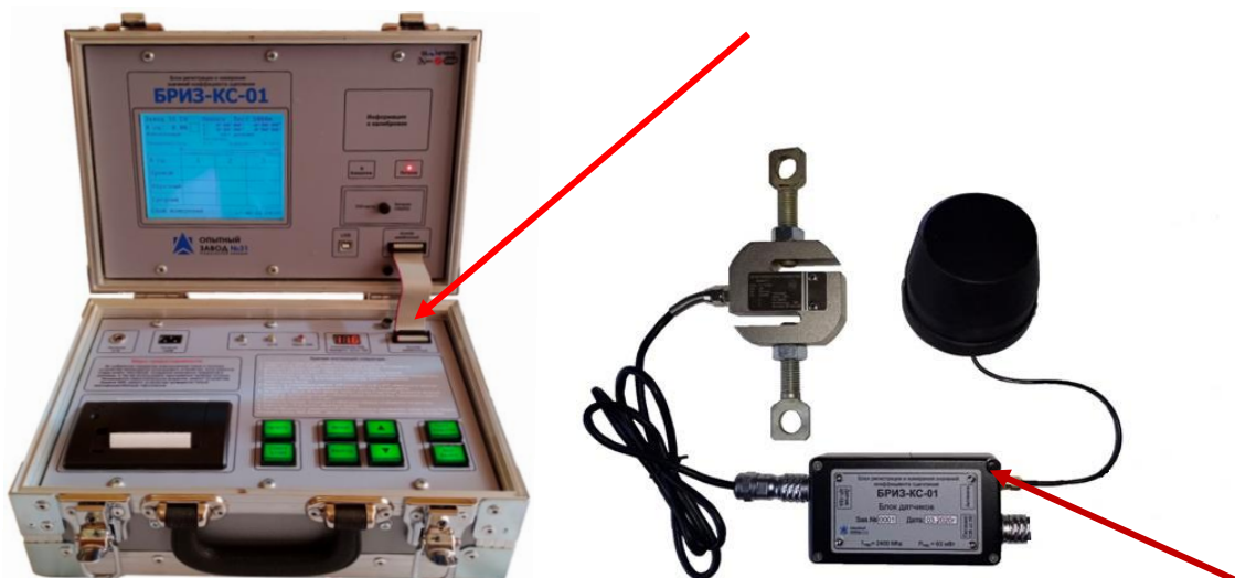
Рисунок 1 – Общий вид блока регистрации измерительного БРИЗ-КС-01 и схема пломбировки от несанкционированного доступа
