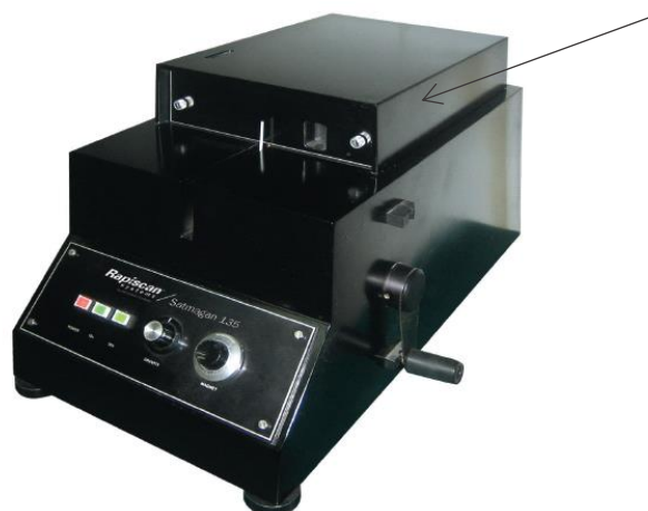
Рисунок 1 – Общий вид анализатора Satmagan 135, обозначение места нанесения знака поверки
