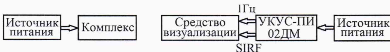
Рисунок 1 – Схема проведения измерений при определении допустимой абсолютной погрешности привязки текущего времени комплекса к шкале времени UTC(SU)
