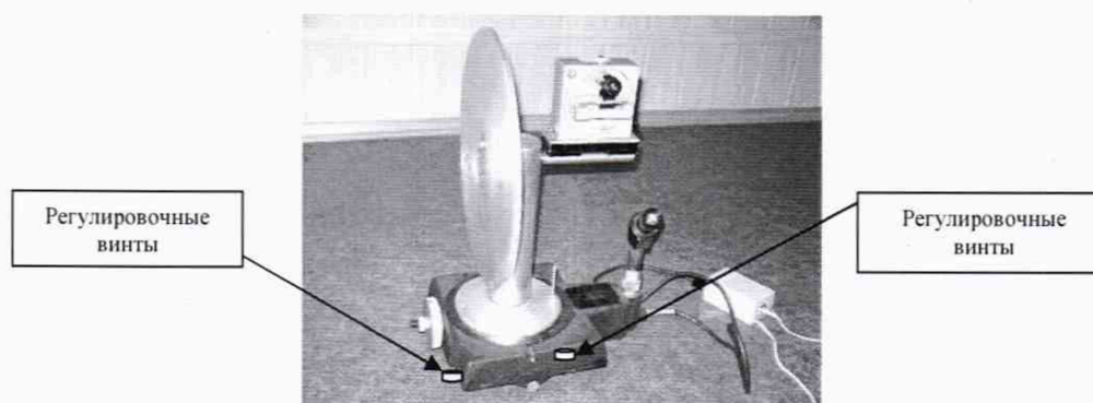
Рисунок 1 – Установка угломерная на основе столов поворотных СТ-9
