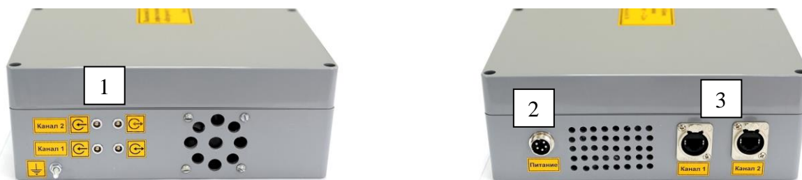
1 - разъемы для подключения ПЭП; 2 - разъем питания; 3 - разъемы RJ45.
