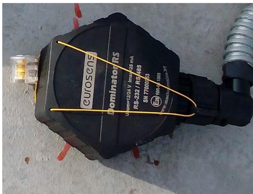
а) первый способ пломбировки датчиков
