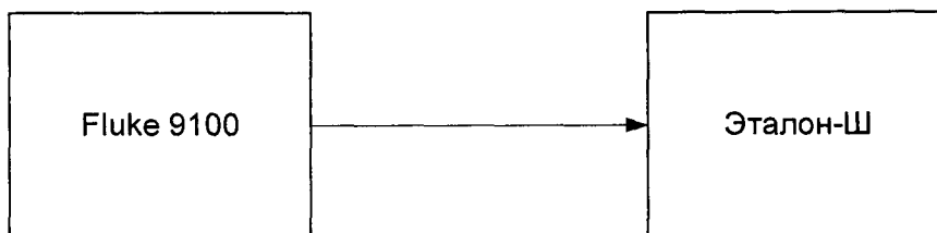
Рисунок 1 – Структурная схема подключения измерителя для опробования, подтверждения соответствия программного обеспечения и определения метрологических характеристик
