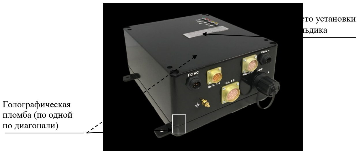
Рисунок 1 Общий вид БОС и схема пломбирования голографической наклейкой от несанкционированного доступа и место установки шильдика
