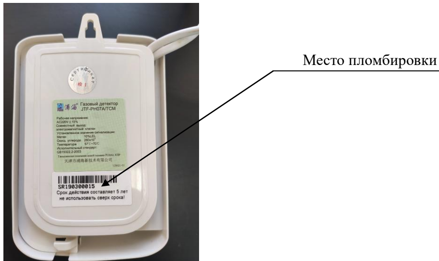
Рисунок 2 – Схема пломбирования от несанкционированного доступа
