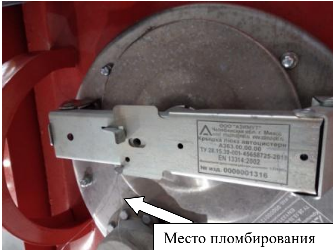
Рисунок 3 – Запорный механизм крышки заливной горловины и кран шаровый узла выдачи топлива (УВТ)
