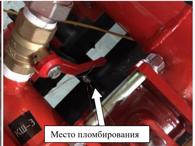
Рисунок 3 – Запорный механизм крышки заливной горловины и кран шаровый узла выдачи топлива (УВТ)
