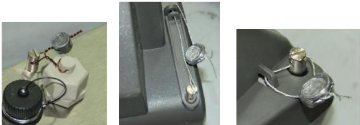
Рисунок 4 - Схема пломбировки от несанкционированного доступа
