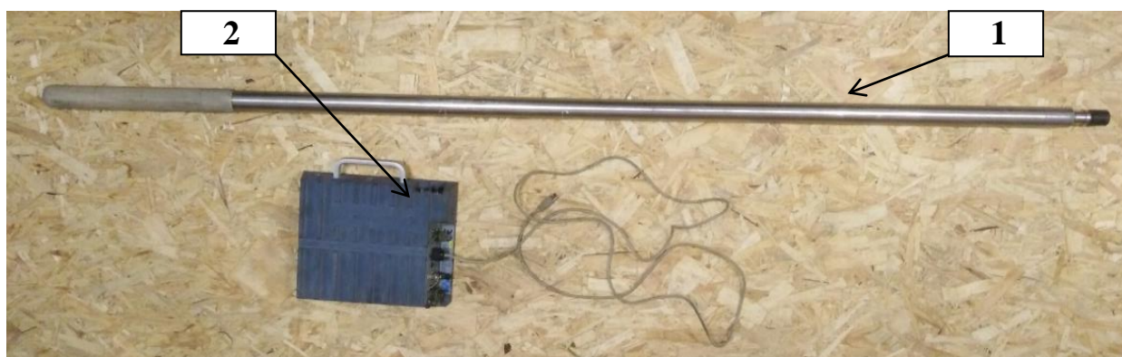
Рисунок 1 - Общий вид прибора в составе: 1 – скважинный зонд, 2 – блок считывающего устройства MicroLogger
