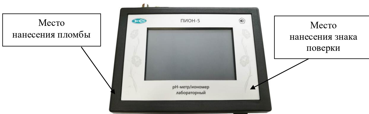
Рисунок 4 – Схема пломбировки от несанкционированного доступа и место нанесения знака поверки
