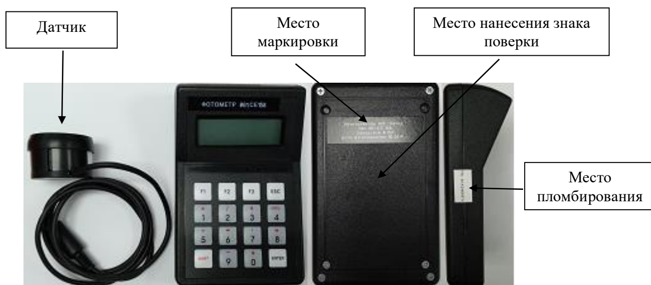
Рисунок 1 - Общий вид фотометров со схемой пломбировки от несанкционированного доступа и обозначением места нанесения знака поверки
