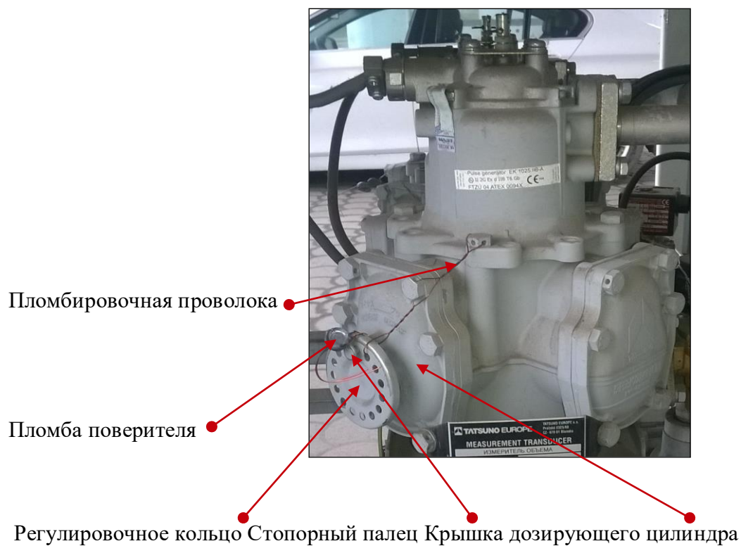
Рисунок 2 – Пломбирование измерителя объема
