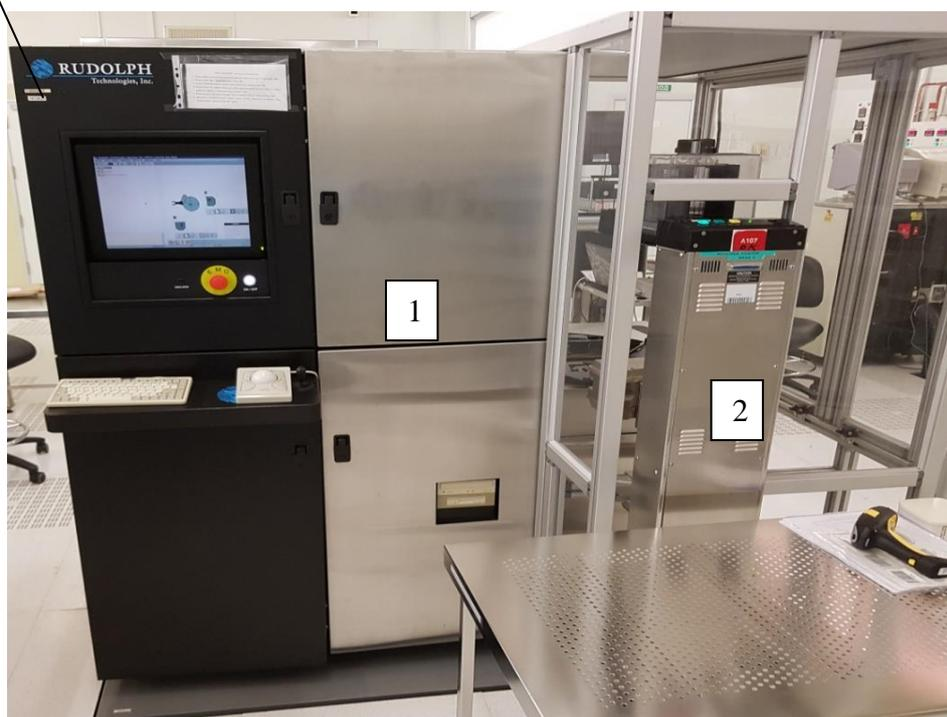
Рисунок 1 - Общий вид установки (1 – измерительный модуль, 2 – SMIF-загрузчик)
