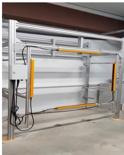
Рисунок 2 – Общий вид измерителей геометрических параметров бревен ВЕКТОР-2D
