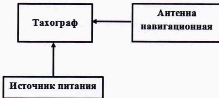
Рисунок 1 – Схема проведения измерений при опробовании
