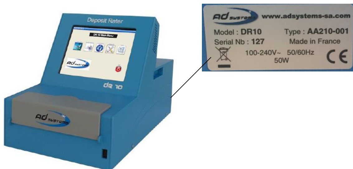
Рисунок 1 – Общий вид приборов интерферометрических для оценки толщины отложений на нагревательных трубках DR 10
