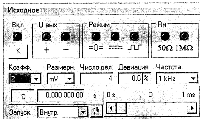
Рисунок 5 – Начальные положения органов управления на панели управления «УИ K2C-62A КУ» при определении абсолютной погрешности измерений напряжения каждого из каналов ЦО НЧ поверяемой установки
