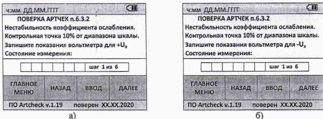
а) б) Рисунок 9 – Вид меню "ПОВЕРКА АРТЧЕК п.6.3.2" при первых двух шагах в контрольной точке 10%
