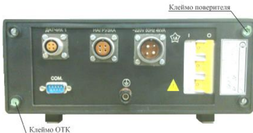
Рисунок 2 – Схема пломбирования термостатов регулируемых ТР-1М
