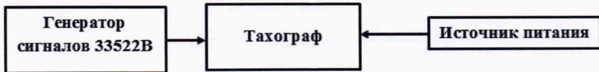
Рисунок 3 – Схема проведения измерений при определении абсолютной инструментальной погрешности измерений скорости по датчику движения
