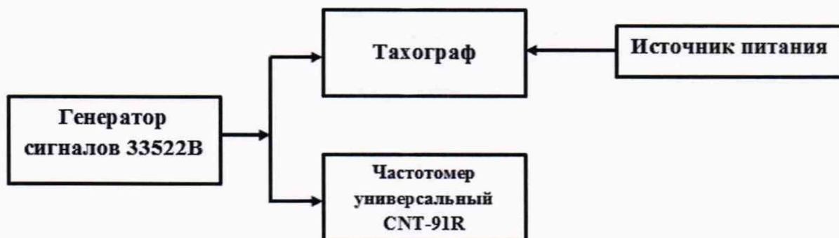
Рисунок 2 – Схема проведения измерений при определении абсолютной погрешности измерений интервала времени и абсолютной инструментальной погрешности измерений пройденного пути
