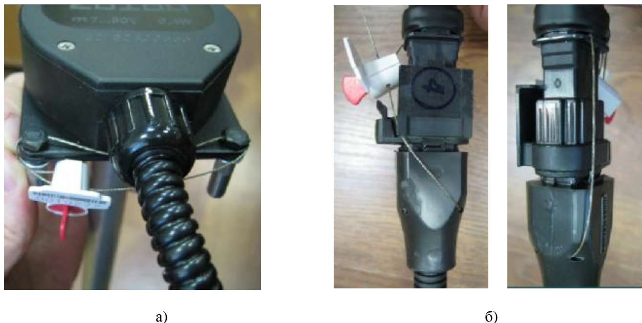
Рисунок 2 – Схема пломбировки при монтаже, обозначение мест установки пломбы монтажной организацией а) схема пломбирования крышки датчика уровня; б) схема пломбирования разъёма
