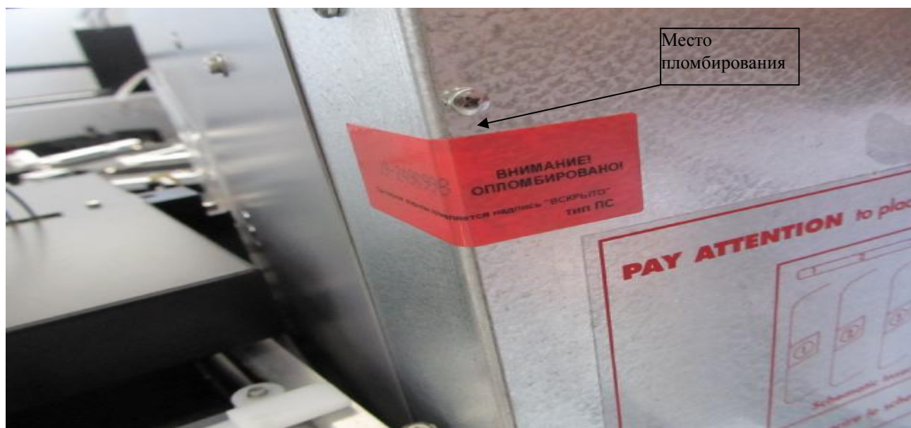
Рисунок 2 – Способ и место пломбирования блока плат системы
