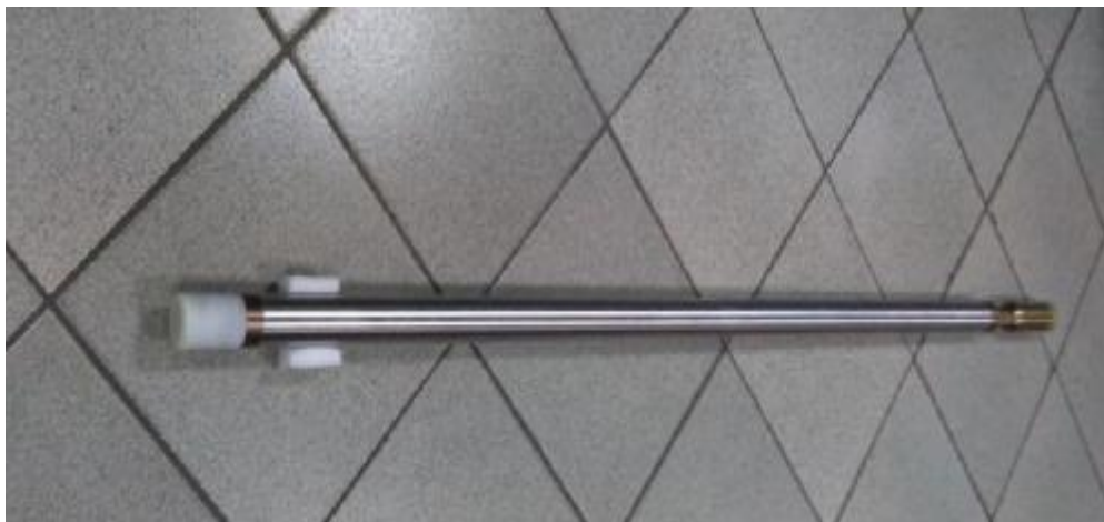
Рисунок 1 – Внешний вид забойной части модуля инклинометрии ЕС.12.01.00.00.000
