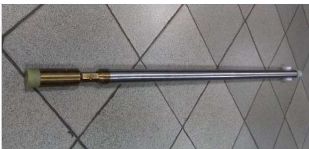
Рисунок 2 – Внешний вид забойной части модуля инклинометрии ЕС.12.01.00.00.000-01
