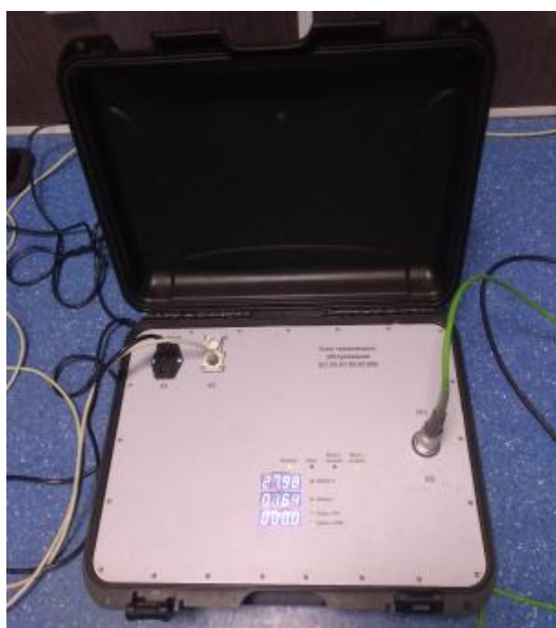
Рисунок 3 – Внешний вид наземной части модулей инклинометрии ЕС.12.01.00.00.000, ЕС.12.01.00.00.000-01 (Блок технического обслуживания ЕС.05.07.00.00.000)
