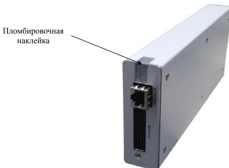
Рисунок 6 - Место пломбирования от несанкционированного доступа модуля НЭП-512С
